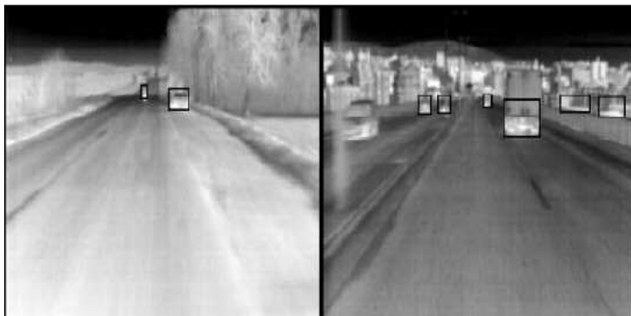
Figure 2.31 — Détection de véhicules par IR : rectangles noirs
